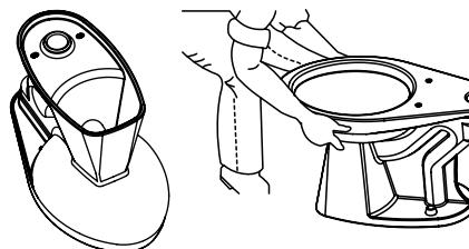
5.- Fije la taza al piso con la ayuda del sistema de fijación (3), luego conecte mediante una manguera de 7/8" a 1/2" (no incluida) el sanitario a la red hidráulica.
