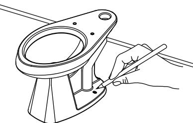
3.- Retire la taza (2), realice los barrenos y coloque taquetes dentro de estos.
