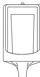
Coloque el mingitorio sobre los soportes e instale la salida de agua en la tubería del desagüe. Coloque los tornillos en las perforaciones para sujeción. Por último, instale el fluxómetro según las instrucciones del fabricante.
