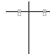
Trace una línea horizontal entre las perforaciones de sujeción, y al centro de esa línea trazar una línea vertical de la medida marcada en el paso anterior. Instale los soportes y realice las perforaciones para la sujeción.
