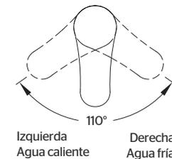
Para regular la temperatura del agua, gire la palanca hacia la izquierda (agua caliente) y hacia la derecha (agua fría).
