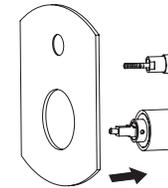
Teniendo el muro terminado, prosiga con la colocación de la Cubierta (4) en el Cuerpo (1); la cual entra a presión hasta topar en la pared.
