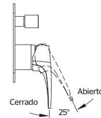
Para abrir el flujo de agua, jale la palanca hacia arriba. Para cerrar el flujo empuje la palanca hacia abajo.
