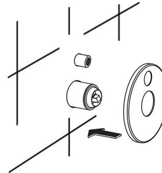
2- Una vez realizada la conexión a la red hidráulica, realice el terminado del muro y retire el protector (23). Tome la cubierta (8) y asegúrese que los empaques (9) y (11) estén correctamente colocados, enseguida introdúzcala en el casquillo hasta topar con la pared.
