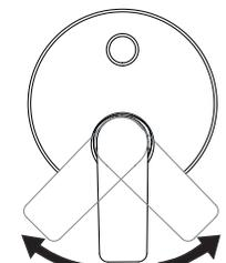
2- Para regular la temperatura del agua, gire el maneral (3) hacia la izquierda (agua caliente) y hacia la derecha (agua fría).
