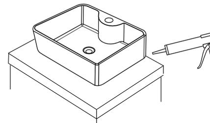
4- Remueva el exceso de pegamento con una estopa. Coloque pegamento nuevamente donde sea necesario. Limpie el lavabo inmediatamente después de su colocación.
