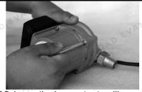
Afloje y retire los cuatro tornillos que fijan la tapa al resto de la bomba.
