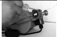
Afloje y retire los cuatro tornillos que fijan la tapa del sensor al resto del sensor.
